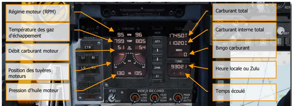
Figure 9. Indicateur intégré carburant et moteur (IFEI)
