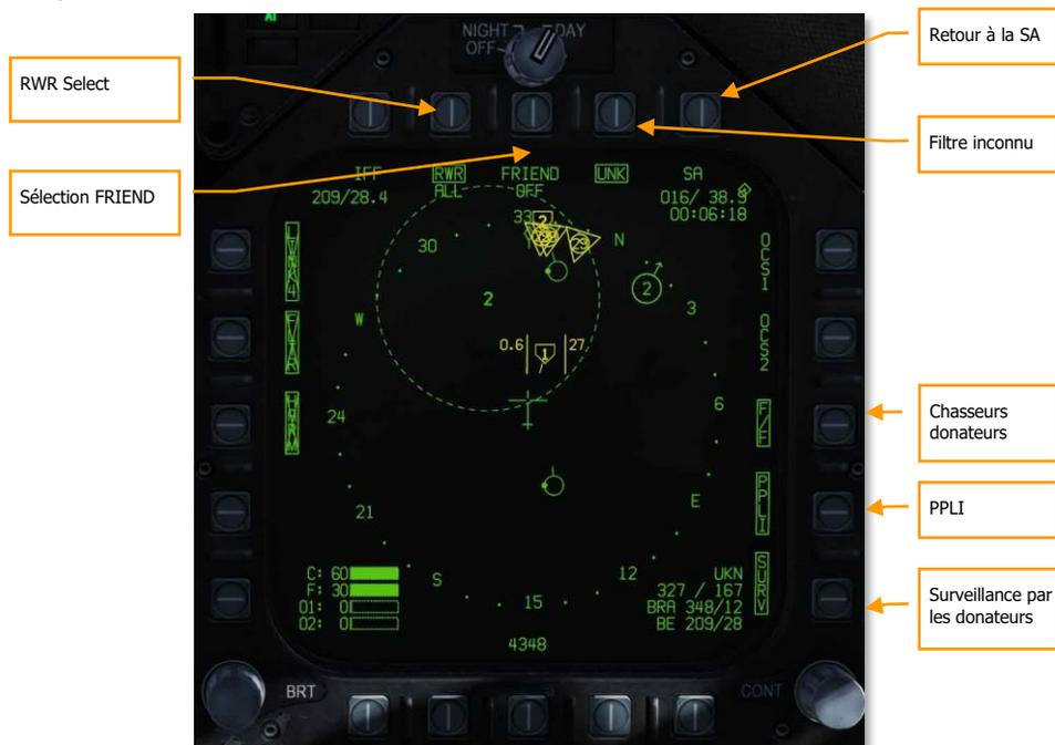
Figure 131. Sous-niveau capteurs page SA
