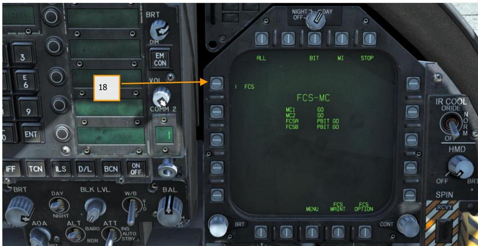
19. Test « quatre en bas ». Cyclez / testez la perche de ravitaillement, les aérofreins, la barre de catapultage, la crosse d'appontage, la réchauffage pitot et réglez les volets sur HALF. [|CONSOLE GAUCHE, MANETTES DE GAZ, QUART DE PANNEAU GAUCHE, QUART DE PANNEAU DROIT et CONSOLE DROITE|](#).
