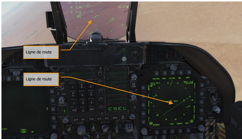
Figure 61. Réglage de la route sur le HSI et le HUD
