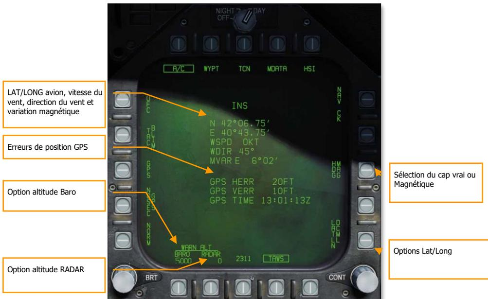
Figure 57. Sous niveau HSI DATA avion
