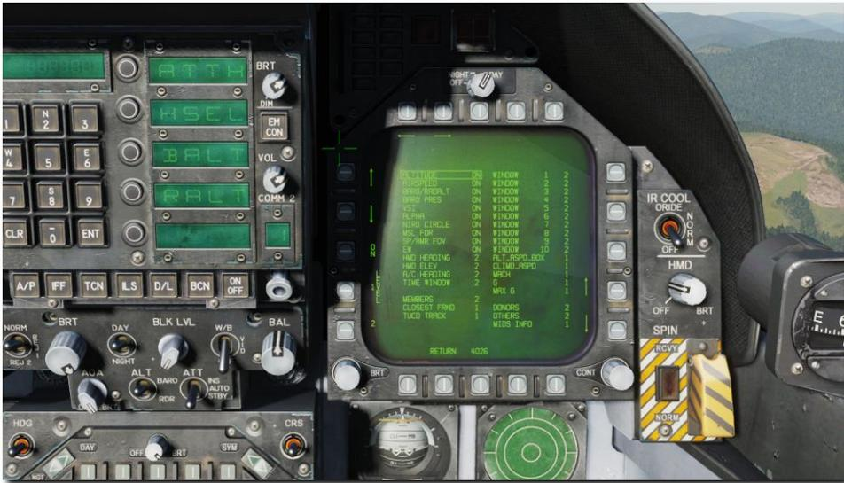
Figure 162. Sous-menu de réglages des rejets HMD
