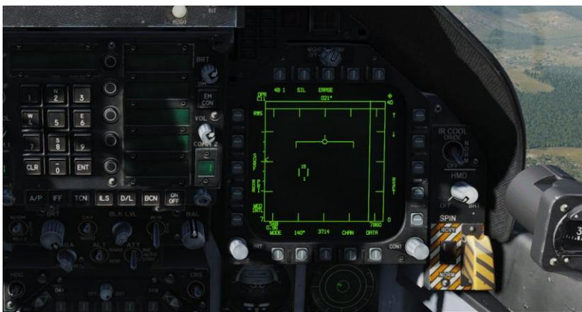
Figure 39. Page RADAR d'attaque
