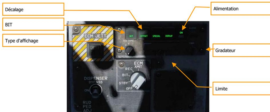
Figure 175. Panneau de commande de l'indicateur
