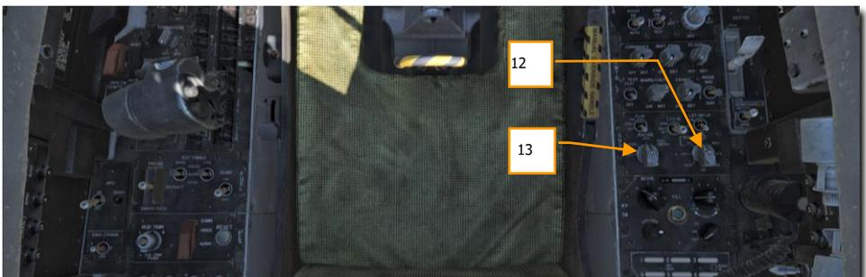
12. Une fois le régime du moteur gauche supérieur à 60 %, tournez le bouton INS sur GND (terre) ou CV (porte-avions), selon l'emplacement du stationnement. **[CONSOLE DROITE]**
