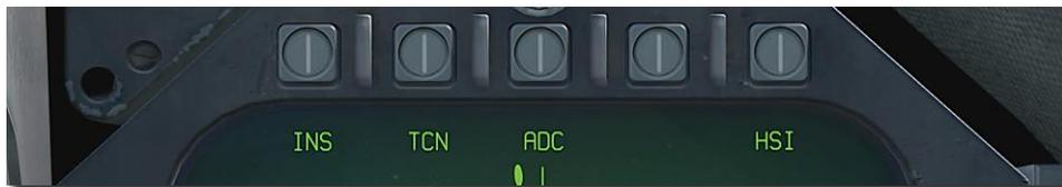
Figure 44. Sélection de la source de suivi de position
