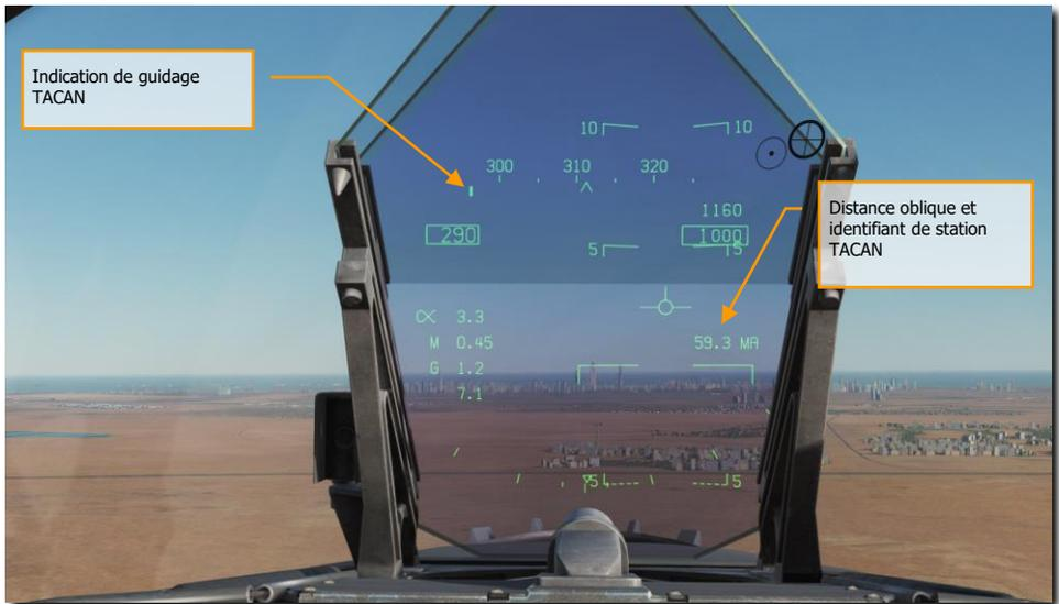
Figure 56. Guidage TACAN sur le HUD
