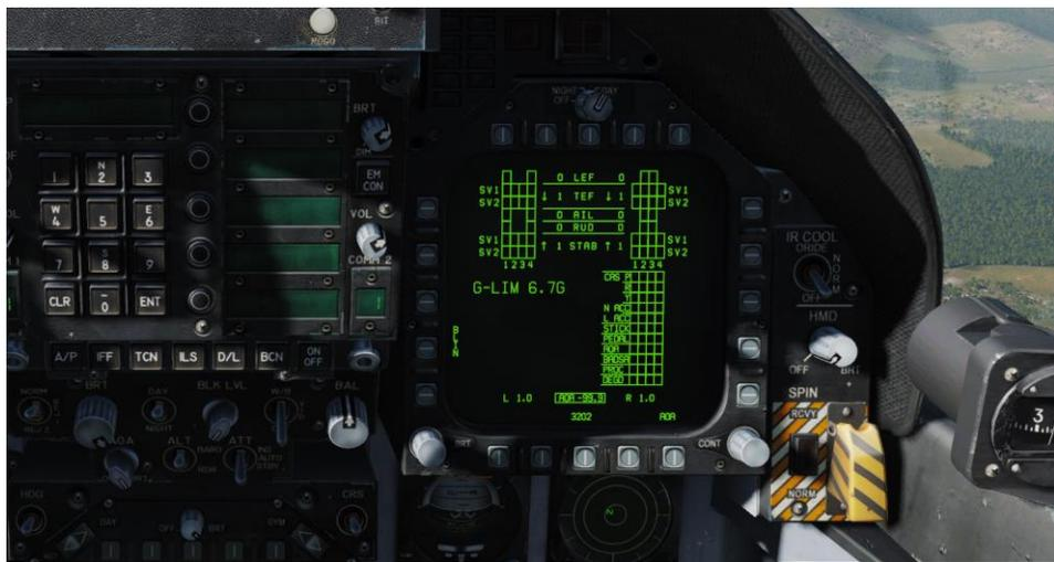
Figure 29. Page systèmes des commandes de vol (FCS)
