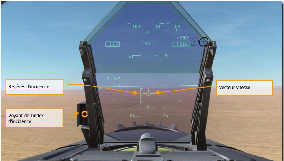
Tournez vers l'étape de base tout en maintenant la vitesse d'incidence lorsque votre extrémité d'aile s'aligne sur le seuil de piste. Votre angle de roulis doit être de 30 degrés et le vecteur vitesse du HUD doit être juste au dessous de la ligne d'horizon. Continuez le virage en descente à la bonne vitesse jusqu'à ce que vous soyez aligné avec le cap d'atterrissage de la piste (une bonne idée est de régler votre route sur le cap de la piste d'atterrissage).
