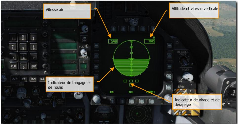
Figure 31. Horizon artificiel électronique (EADI)
