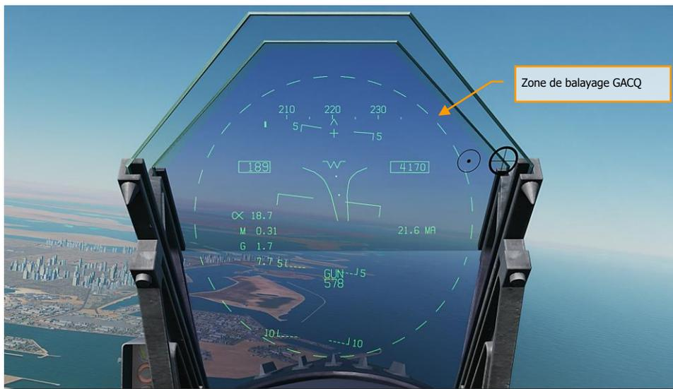
Figure 138. Zone d'acquisition automatique canon A/A
