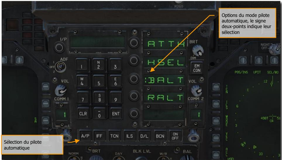
Figure 62. Modes pilote automatique de l'UFC
