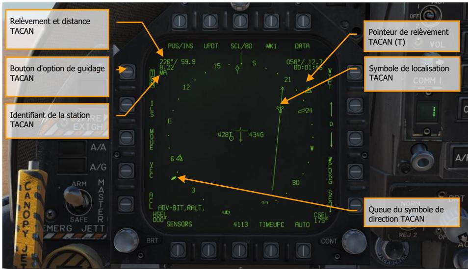
Figure 55. Guidage TACAN sur le HSI
