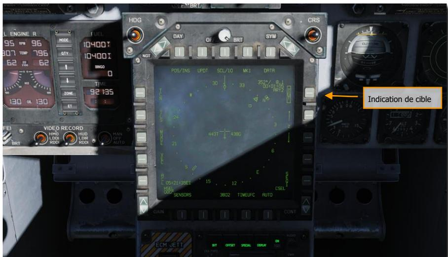
Figure 72. Bombardement AUTO, point de navigation défini comme cible (TGT)
