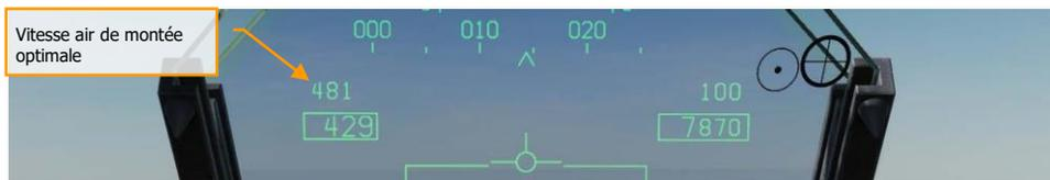
Figure 34. Sélection de montée optimale
