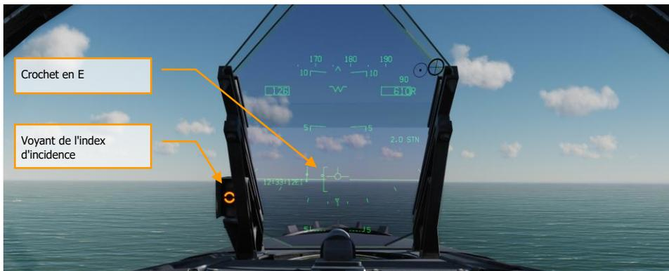
Maintenir la vitesse de bonne incidence à 600 pieds jusqu'à ce que l'arrière du porte-avions soit visible et forme une ligne droite.
