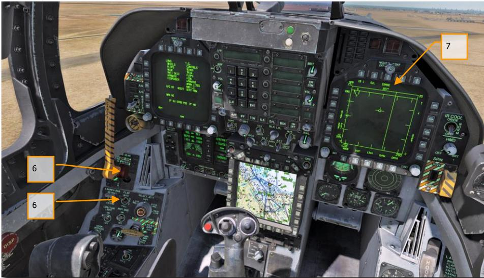
5. À la vitesse de rotation, maintenez le manche en arrière jusqu'à 6 à 8 degrés d'assiette longitudinale (Axe de l'avion au-dessus de la ligne d'horizon sur le HUD)
