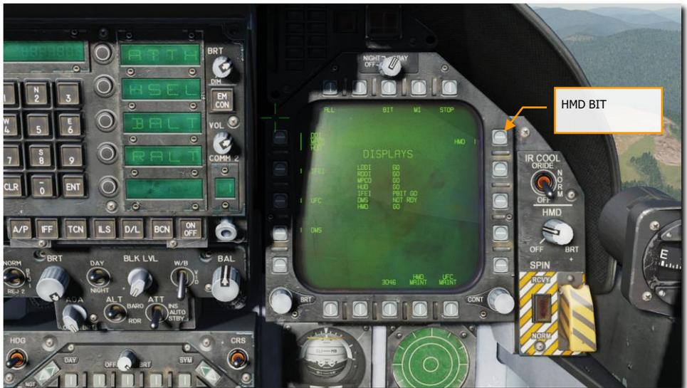
Figure 160. Test intégré du HMD (BIT)
